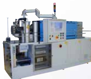
Durchstoßofen Glühen von Wolframteilen unter Wasserstoff-Atmosphäre Pusher-type furnace Annealing of tungsten parts in an hydrogen atmosphere
