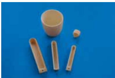
Keramiktiegel und -schiffchen für Synthesen und Reinigung Ceramic crucible and boats for synthesis and purification
