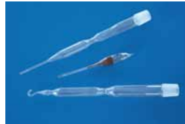
Quarzampullen für Bridgman- und Gasphasenzüchtung Quartz tubes for Bridgman - and growth from the vapour phase
