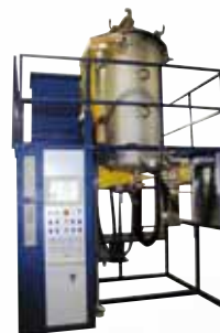
Pyrolyse / Silizieren von Carbonteilen Pyrolyses / Siliconization of carbon samples
