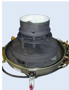
Offener Siliziertiegel Open crucible for siliconization
